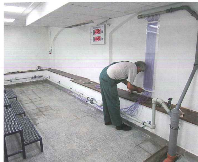
Obr. 6: Instalace tlakově provozované tratě určené pro simulaci ztrát třením po délce a ztrát místních
