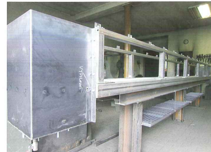
Obr. 3: Pohled na konstrukci měrného žlabu před jeho žárovým zinkováním
